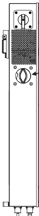
Gire el interruptor de aislamiento de las baterías para encenderlas.
